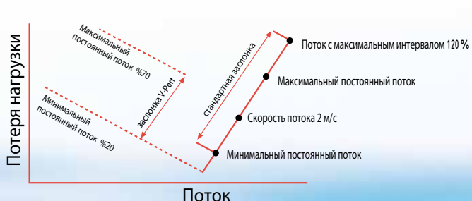
Диапазон потока для различных форм заслонок
